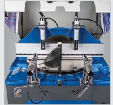
▶ Serienmäßig mit vier pneumatischen Spannzylindern
