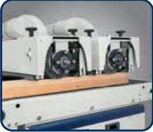
▶ Arbeitsaggregate können einzeln zugeschaltet werden
