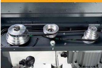
Abb. Riemenantrieb DQ 22.
