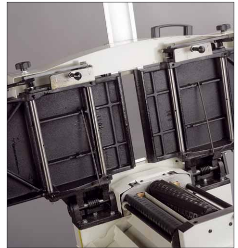
Um die Maschine als Dickenhobel zu verwenden, wird der Tisch im Ganzen hochgeklappt. Das Anheben wird durch große Stahlfedern unterstützt. Gegen ein Zurückfallen ist der Abrichttisch durch eine Stahllasche gesichert
