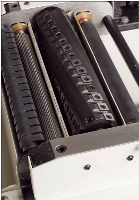
Hier ist gut die Transportwelle zu erkennen, die das Holz in die Maschine zieht
