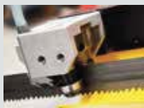
Sägebandführung aus Hartmetall
