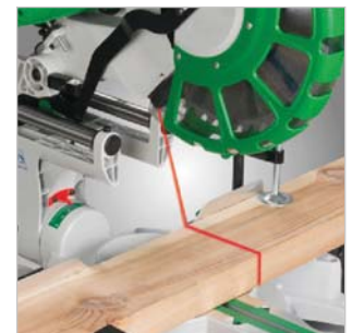
Laserprojektion auf dem Werkstück zur genauen Kontrolle der Schnittposition
