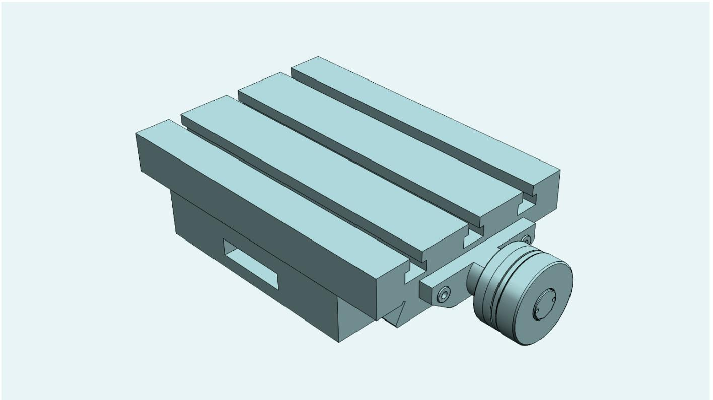
Leicht Stationäre Verschiebetische mit einer Achse. Für eine Anwendung in Lineareinheiten. Erlaubt die Arbeit in horizontale sowohl in vertikale Position. Alle Elemente sind in Grauguss GG25 stabilisiert. Millimeter Regeln XY. Chrom matt Nonius, mit Null-Einstellrad. Dreiecks Spindel mit einstellbare Mutter. Standard-Blockierung -M6.
