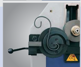
Zubehör ▶ Anwendung Spiralbiegen mit optionalem Biegewerkzeug
