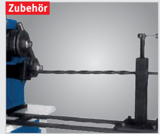
Zubehör ▶ Optionales Biegewerkzeug zum Drehen von z.B. schmiedeeisernen Zierstäben (Abb. ähnlich)
