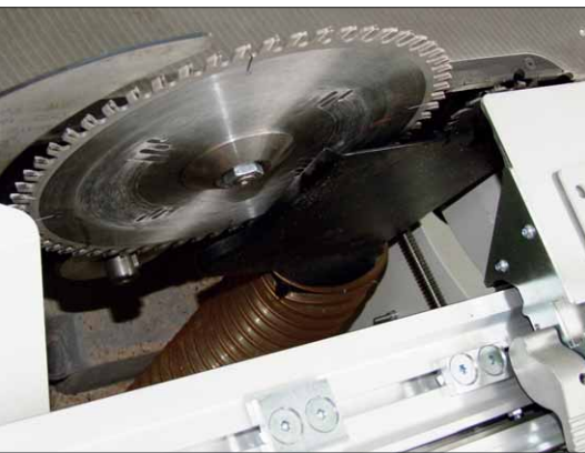
Wird das Schutzblech entfernt, kann das Sägeblatt sehr einfach gewechselt werden
