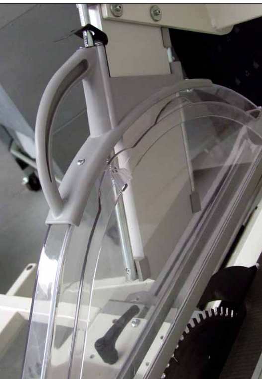
Je nach dicke des Holzes, wird der schwebendes Sägeblattschutz an seinem Arm nach oben geschoben
