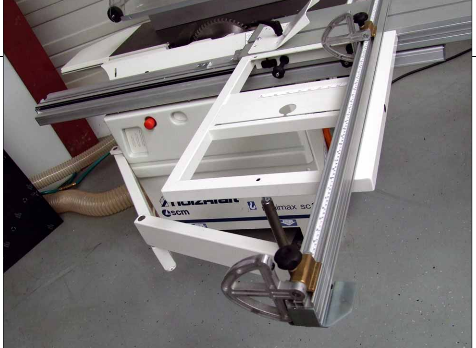
Am Anschlag des Schiebeschlittens befinden sich zwei Anschläge für Serienschritte
