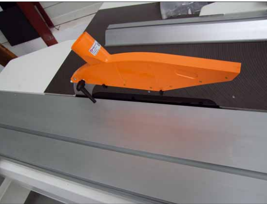
Der am Spaltkeil befestigte Sägeblattschutz wird beim Schwenken des Blattes einfach mitgeführt
