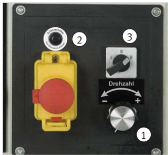
Variable Drehzahlregulierung von 0-1.200 min -1 (L) und 0-3.200 min -1 (H) in zwei Geschwindigkeitsstufen.
