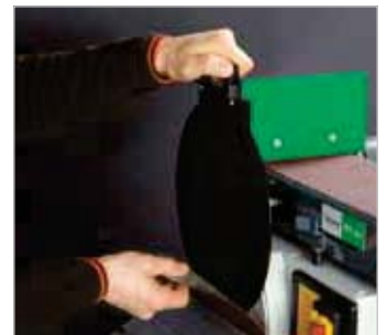
Mit integriertem Absaugstutzen für den Anschluss an eine externe Absaugeinrichtung
