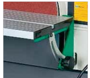
Der BTS 250 ist für mehr Stabilität beidseitig geführt
