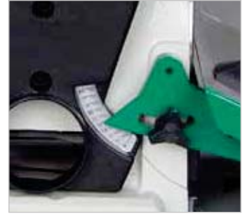
Der robuste Arbeitstisch ist von 0° bis 45° schwenkbar. Die eingestellte Neigung kann anhand einer Skala abgelesen werden.
