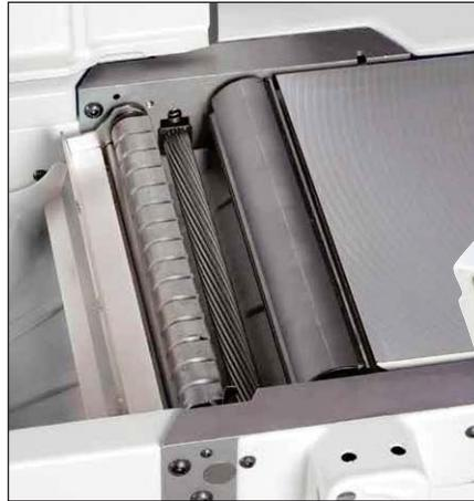
Alle HOLZKRAFT-Hobelaggregate haben eine schrägverzahnte Stahleinzugswalze, die für einen noch konstanteren und gleichmäßigeren Materialeinzug sorgt, auch bei geringem Anpressdruck.
