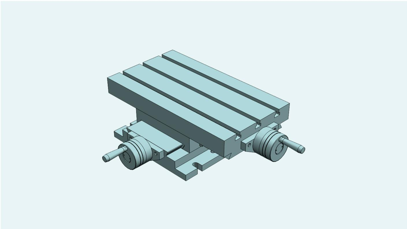
Stationäre Koordinatentische mit 2 Achsen, entwickelt für den Gebrauch auf Bohr- und Fräsmaschinen, Sondervorrichtungen zum Verschieben und in anderen mechanischen Vorrichtungen die die Kontrolle des Verfahrweges X-Y benötigen. Alle Elemente sind in Grauguss GG25 stabilisiert. Millimeter Regeln XY. Chrom matt Nonius, mit Null-Einstellrad. Trapezspindel mit einstellbare Mutter. Standard-Blockierung -M6.
