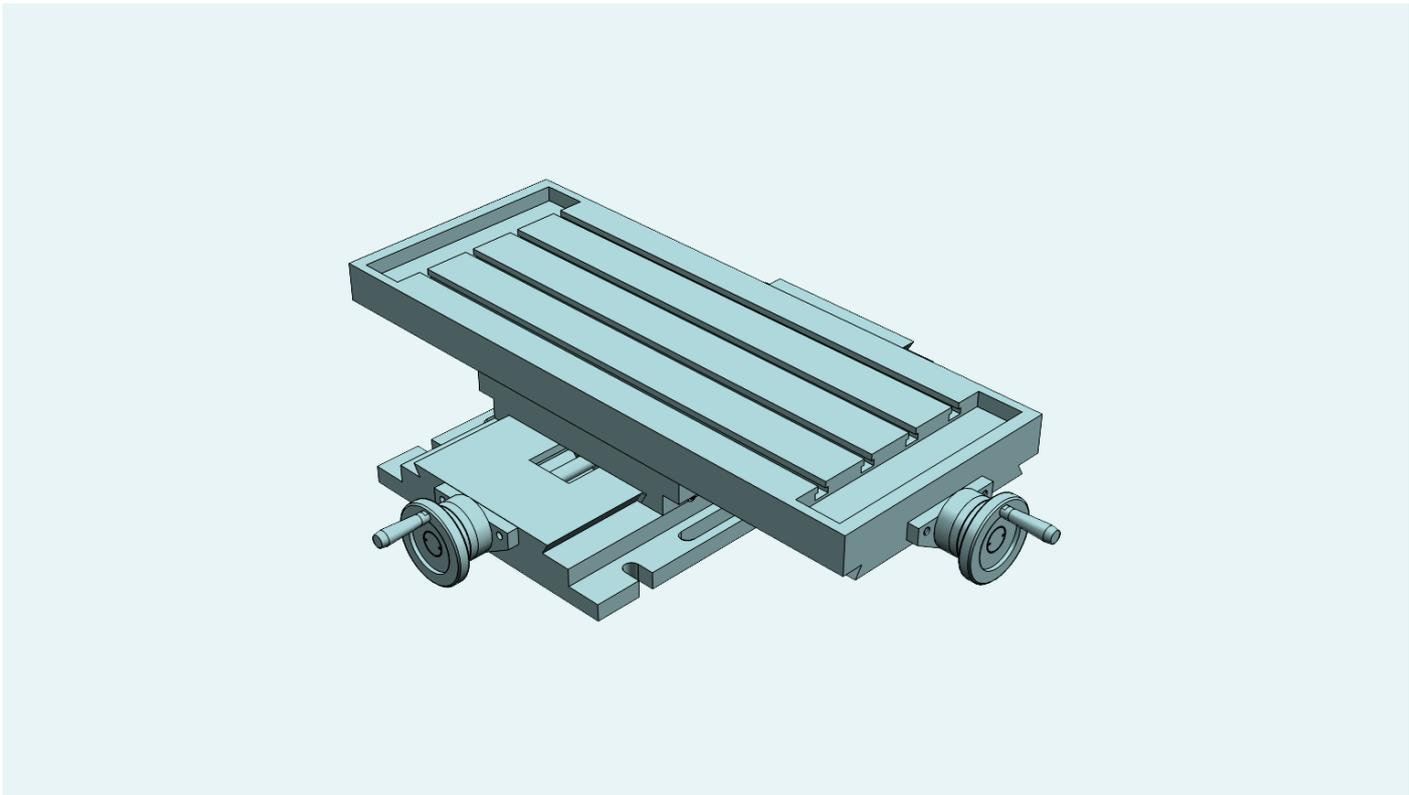
Stationäre Koordinatentische mit 2 Achsen, entwickelt für den Gebrauch auf Bohr-und Fräsmaschinen, Sondervorrichtungen zum Verschieben und in anderen mechanischen Vorrichtungen die die Kontrolle des Verfahrweges X-Y benötigen. Alle Elemente sind in Grauguss GG25 stabilisiert. Millimeter Regeln XY. Chrom matt Nonius, mit Null-Einstellrad. Trapezspindel mit einstellbare Mutter. Standard-Blockierung -M6. Konstruiert um die bei den Werkzeugmaschinen verwendeten Kühlflüssigkeiten aufzunehmen
