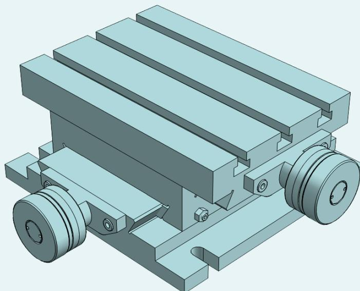
Stationäre Koordinatentische mit 2 Achsen, entwickelt für den Gebrauch auf Bohr-und Fräsmaschinen, Sondervorrichtungen zum Verschieben und in anderen mechanischen Vorrichtungen die die Kontrolle des Verfahrweges X-Y benötigen. Alle Elemente sind in Grauguss GG25 stabilisiert. Millimeter Regeln XY. Chrom matt Nonius, mit Null-Einstellrad. Dreiecks Spindel mit einstellbare Mutter. Standard-Blockierung -M6.
