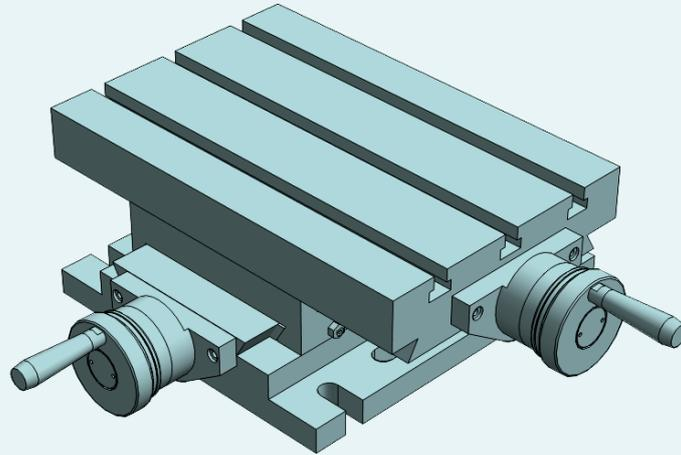
Stationäre Koordinatentische mit 2 Achsen, entwickelt für den Gebrauch auf Bohr-und Fräsmaschinen, Sondervorrichtungen zum Verschieben und in anderen mechanischen Vorrichtungen die die Kontrolle des Verfahrweges X-Y benötigen. Alle Elemente sind in Grauguss GG25 stabilisiert. Millimeter Regeln XY. Chrom matt Nonius, mit Null-Einstellrad. Trapezspindel mit einstellbare Mutter. Standard-Blockierung -M6.
