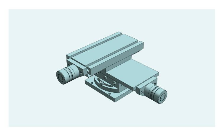
Drehbare Koordinatentische mit 2 Achsen, wie Ausführung MF MINI, jedoch mit der zusätzlichen Möglichkeit der Drehbewegung von 60°. Alle Elemente sind in Grauguss GG25 stabilisiert. Millimeter Regeln XY. Chrom matt Nonius, mit Null-Einstellrad. Dreiecks Spindle mit einstellbare Mutter. Standard-Blockierung -M5.
