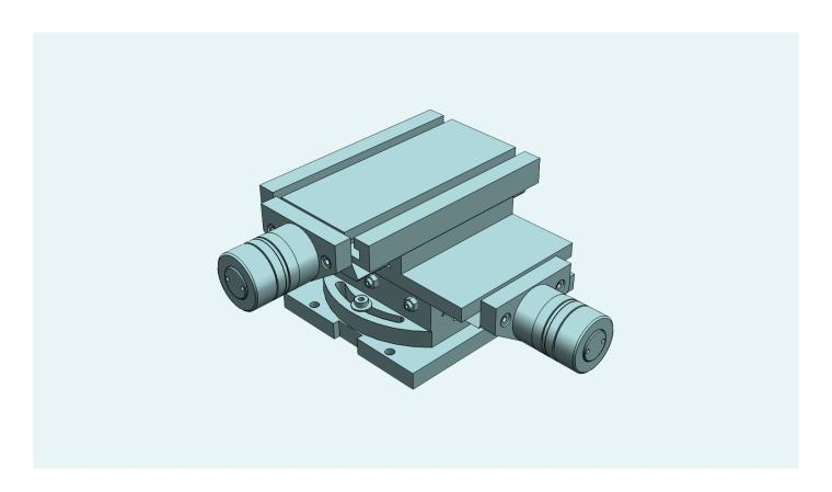
Drehbare Koordinatentische mit 2 Achsen, wie Ausführung MF MINI, jedoch mit der zusätzlichen Möglichkeit der Drehbewegung von 60°. Alle Elemente sind in Grauguss GG25 stabilisiert. Millimeter Regeln XY. Chrom matt Nonius, mit Null-Einstellrad. Dreiecks Spindle mit einstellbare Mutter. Standard-Blockierung -M5.
